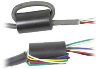
Figure 2-12 : Installation des noyaux de ferrite
