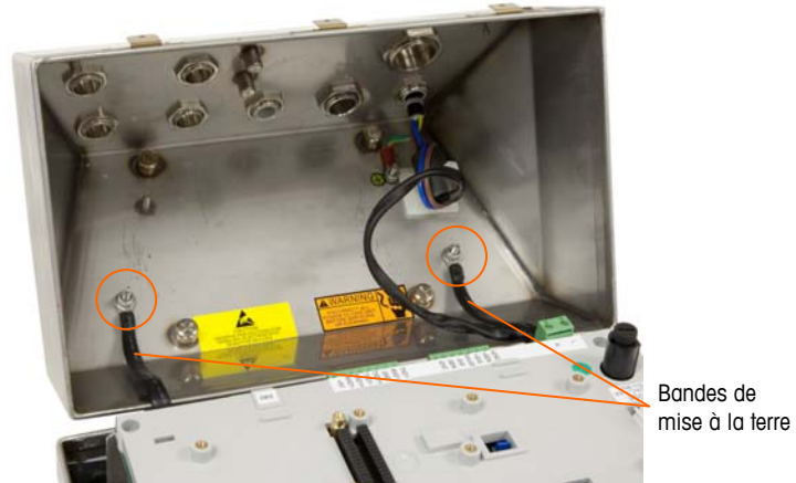
Figure 2-9 : Desserrage des bandes de mise à la terre
