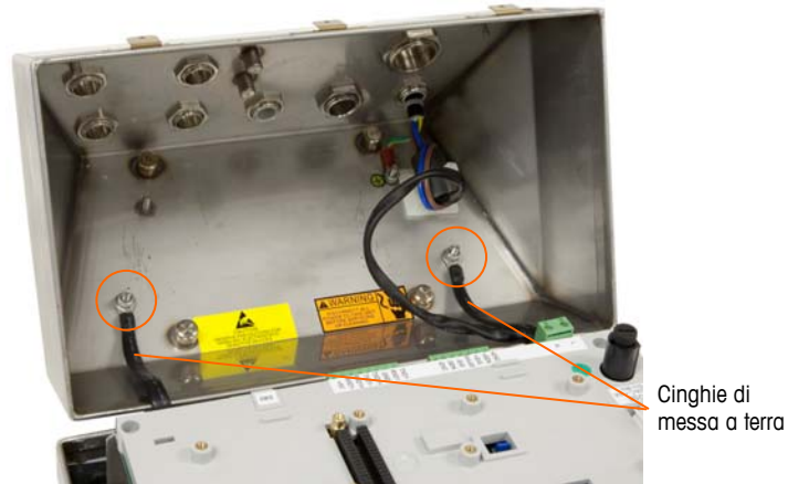
Figura 2-9: Allentamento delle cinghie di terra
