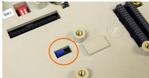
Figura 2-52: Posizione del ponticello Millivolt W1, Coperchio del PCB principale installato
