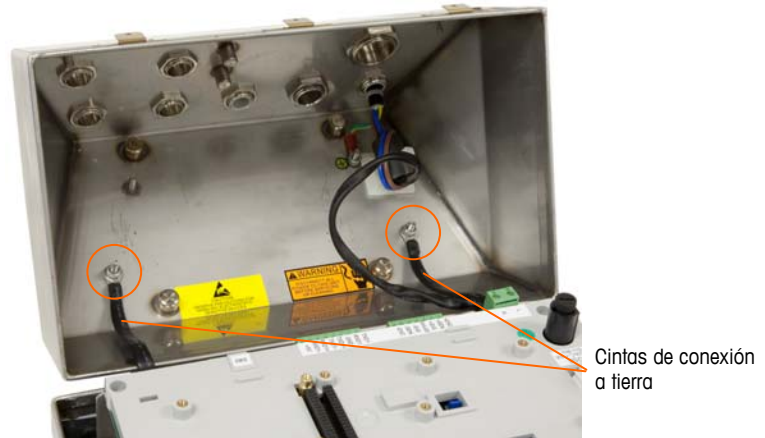
Figura 2-9: Para aflojar las cintas de conexión a tierra
