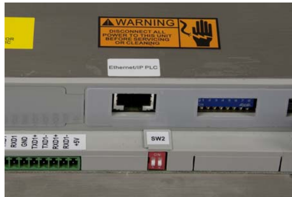
Figure 2-47: Emplacement de l'étiquette EtherNet/IP, enceinte pour montage sur tableau
