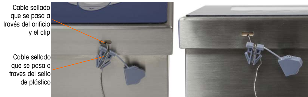
Figura 2-59: Sello para cajas de ambientes adversos enredado y listo para cerrarse -- orientación estándar (izquierda) y con el panel invertido (derecha)
