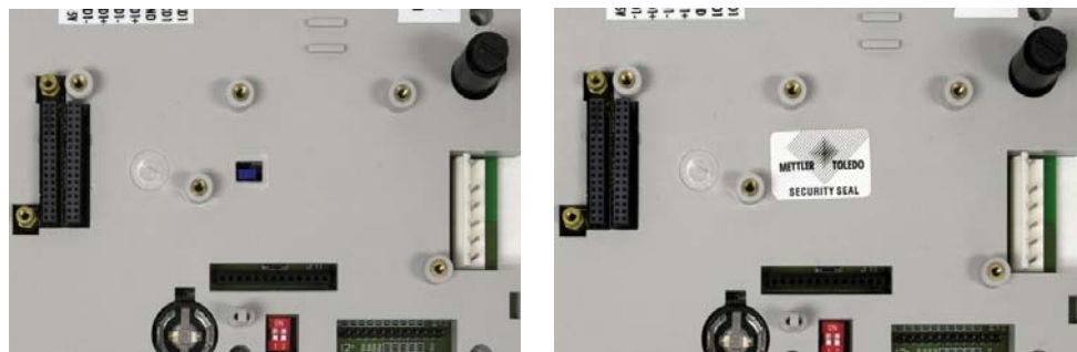
Figura 2-63: Ponticello Millivolt W1, non sigillato (sinistra) e sigillato (destra)
