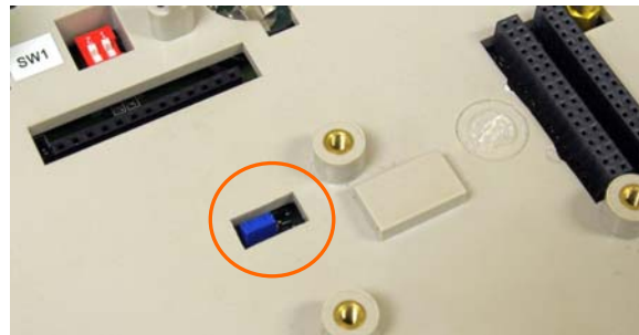
Figure 2-52 : Emplacement du cavalier Millivolt W1, carte principale avec couvercle
