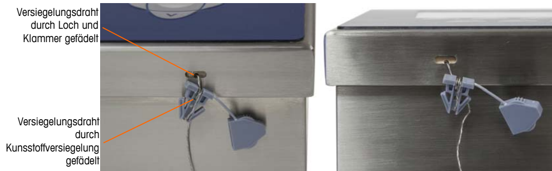
Abbildung 2-59: Siegel für Gehäuse für raue Umgebungen eingefädelt und zum Verschiessen bereit -- Standardausrichtung (links) und mit umgedrehter Platte (rechts)
