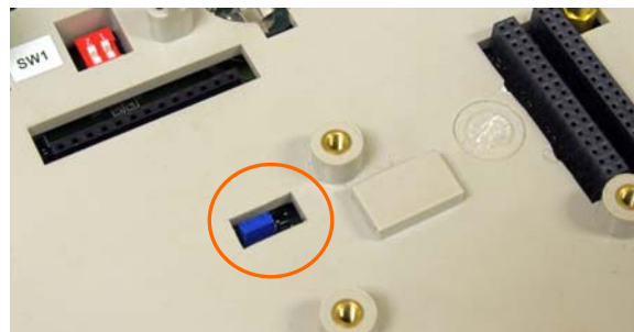
Abbildung 2-52: Lage der W1-Millivolt-Drahtbrücke, Hauptplatine mit Abdeckung
