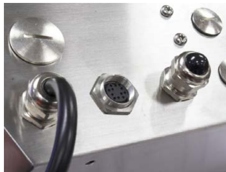
Figura 2-19: Posizione del connettore IDNet sull'armadietto per ambienti difficili
