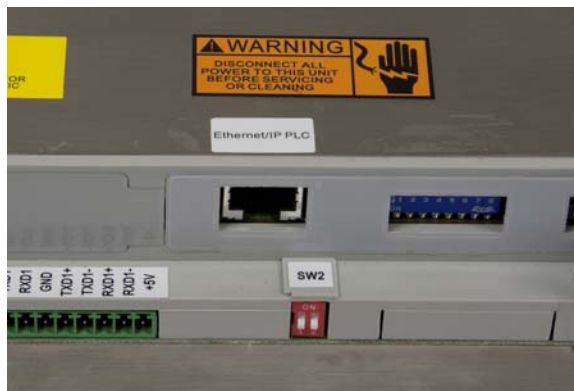
Abbildung 2-47: Platzierung von Ethernet/IP-Etikett, gehäuse für den Schalttafeleinbau
