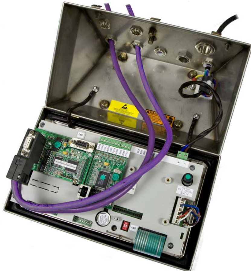
Figure 2-42 : Connexion PROFIBUS pour environnement hostile
