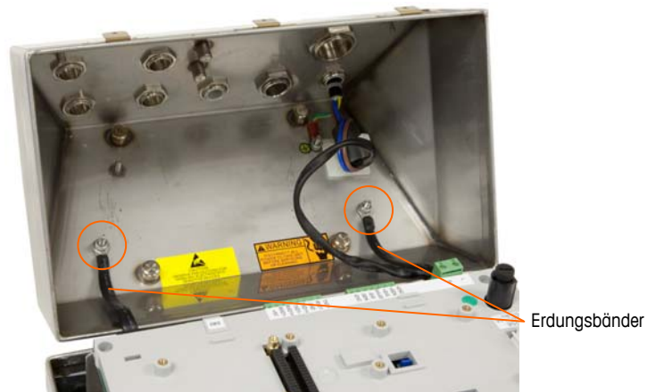
Abbildung 2-9: Lösen der Erdungsbänder
