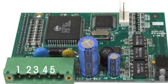
Figura 2-39: Numerazione di pin del connettore sulla scheda opzionale DeviceNet
