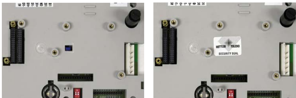
Figure 2-63 : Cavalier Millivolt W1 – Non scellé (gauche) et scellé (droite)
