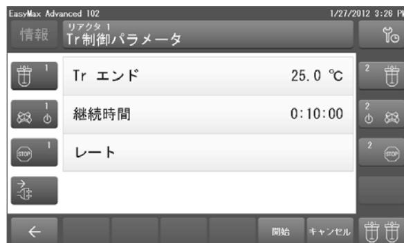
• Advanced(詳細設定)ボタンをタッチすると、昇温あるいは冷却における制御パラメータを入力するメニューを開くことができます。リアクタ内容物の目的とする Tr エンドに到達するまでの時間の長さまたは温度変化のレートを設定することができます。制御パラメータの開始を待機することも可能です。
