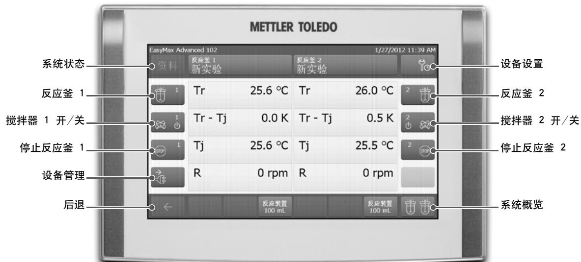
在系统概览中，可以同时监控和更改两个反应釜设置：
