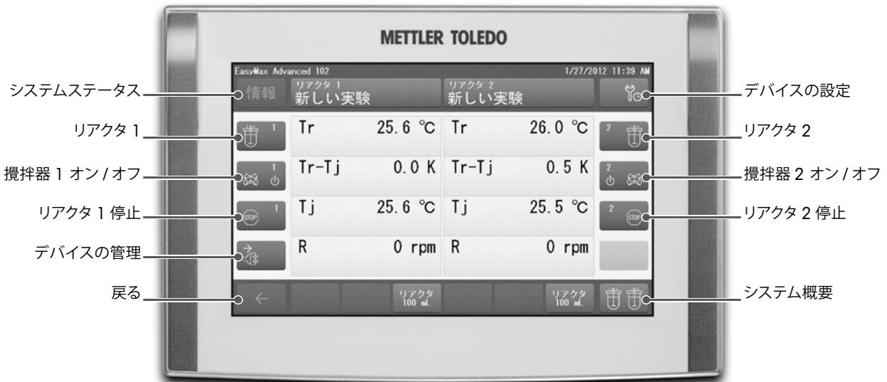
**システムの概要**画面では、両方のリアクタのモニタリングと変更が行えます。
