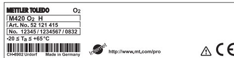
Fig. : Plaque signalétique M420 O 2 H, à l'extérieur, en dessous de la partie avant
