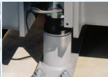
Des plots optionnels réhaussent la bascule pour un meilleur dégagement du fond et un nettoyage plus facile lorsque la neige ou les matières s'accumulent sous celle-ci
