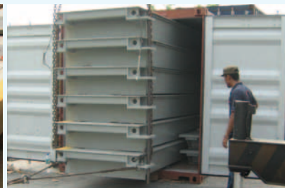
Le VTS se range facilement dans un conteneur maritime standard ou sur une remorque pour diminuer les coûts de transport – plus de convois exceptionnels !
