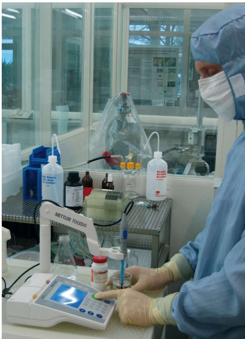
Figure 3 : Markus Keller ajuste à l'aide du SevenMulti™ S47 la valeur exacte du pH d'une solution tampon de phosphate de potassium. Afin de minimiser une éventuelle contamination, des vêtements de protection et des masques sont obligatoires dans la salle la plus propre du monde
