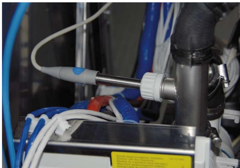
Figure 3 : L'électrode InLab®741 est installée par l'intermédiaire d'une dérivation à côté de l'unité de mesure intégrée
