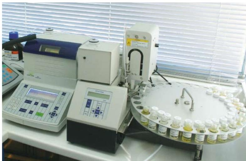
Figure 3 : Après la mesure, les échantillons, récupérés dans les fioles par le passeur d'échantillons, peuvent être utilisés pour la parfumo-thèque
