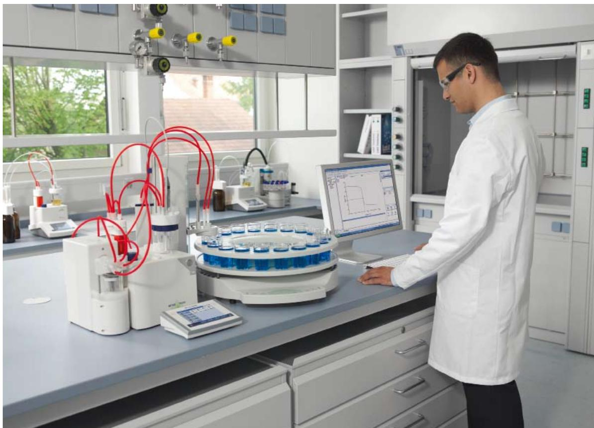
Le système automatique de titrage en service : titreur Excellence T90, passeur d'échantillons Rondo 20, Liquid Handler et LabX® pro titration
