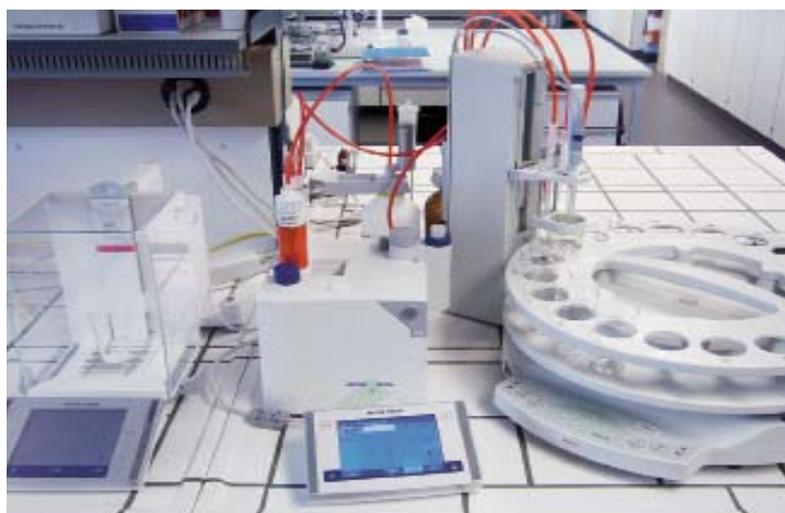
Figure 3 : Titreur Excellence T90 équipé du passeur d'échantillons Rondo 20 et de la balance analytique Excellence
