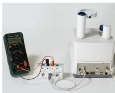
Figure 3 : Mesures d'étalonnage sur le titreur Compact Karl Fischer
