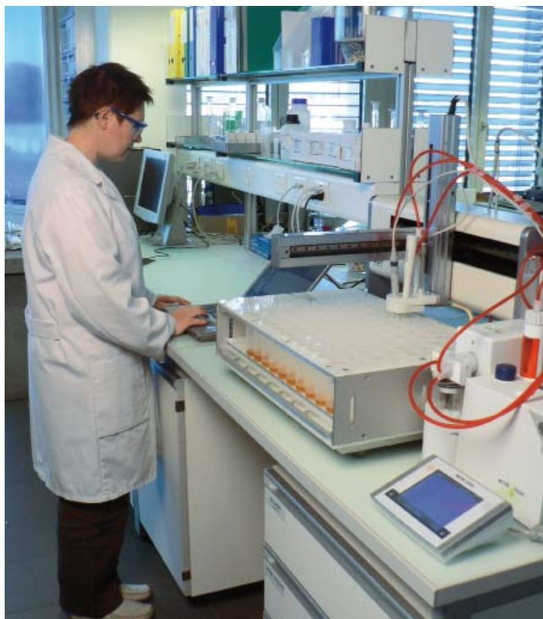
Figure 1 : Système automatique de titrage : T90, Sample Handler et Liquid Handler
