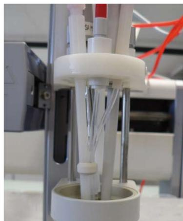
Figure 5 : Fixation des tuyaux de dosage et d'aspiration sur la pipette
