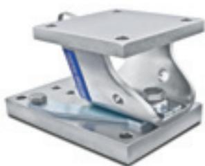
Le module de pesage MultiMount™ sans cellule de pesée et avec fonction SafeLock™ en place évite l'emploi de supports hors tension lors de l'installation. La cellule de pesée peut être installée à tout moment par la suite.
