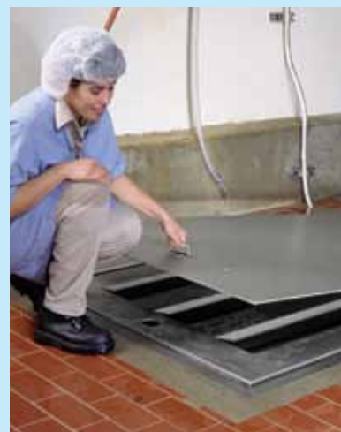
La balance EZ-LIFT possède des supports pneumatiques qui facilitent le levage du plateau pour le nettoyage.
