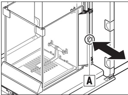
Für die motorische Bedienung des Innenwindschutzes müssen die Kupplungsbolzen (A) **nach innen** gestossen sein. Die beiden Seitentüren können einzeln gesteuert werden.
