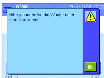
Bevor die Waage in den Wägemodus zurückkehrt, erscheint eine Meldung mit der Empfehlung, die Waage nach der Nivellierung zu justieren. Bestätigen Sie die Meldung mit **OK**.
