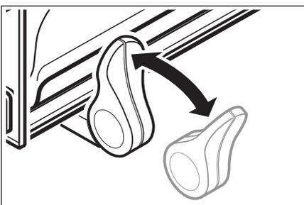
Für die **motorische Bedienung** müssen die Griffe der zu öffnenden Türen eingekuppelt sein:
