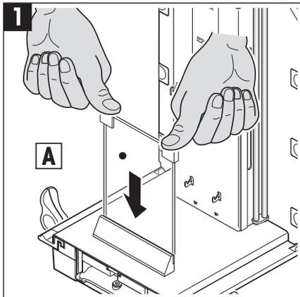
Setzen Sie das Frontglas (A) des Innenwindschutzes ein. Ausgemittelt und bis zum Anschlag eingeschoben.
