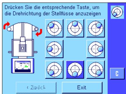
Der Nivellierungs-Assistent zeigt Ihnen mit roten Pfeilen, in welche Richtung Sie die beiden Fußschrauben hinten an der Waage drehen müssen.
