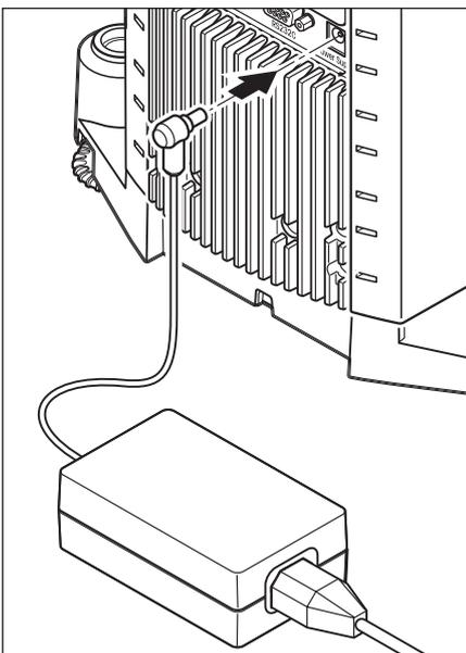
Ihre Waage wird mit einem Netzadapter und einem länderspezifischen Netzkabel ausgeliefert. Der Netzadapter eignet sich für alle Netzspannungen im Bereich von: 100 – 240 VAC, 50/60 Hz
