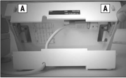
Drücken Sie auf die beiden Knöpfe (A) hinten am Terminal und klappen Sie das Terminaloberteil auf.
