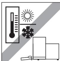
Stabile, erschütterungsfreie und möglichst horizontale Lage wählen. Der Untergrund muss das Gewicht der voll belasteten Waage sicher tragen können.
