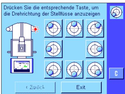
Beobachten Sie die Libelle Ihrer Waage (diese ist bei eingeschaltetem Neigungssensor beleuchtet) und drücken Sie die Schaltfläche, die der aktuellen Position der Luftblase in der Libelle entspricht.
