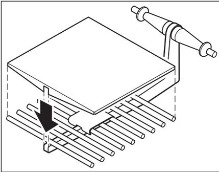
Für die Montage nehmen Sie die Gitterwaagschale aus dem Wägeraum.
