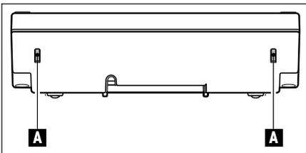
Um den Ablesewinkel zu ändern drücken Sie an der Rückseite des Terminals die beiden Knöpfe (A) nach innen. Sie können jetzt das Terminaloberteil nach oben oder unten ziehen, bis es in der gewünschten Position einrastet. Insgesamt stehen 3 Einstellpositionen zur Verfügung.
