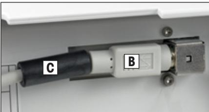
Prüfen Sie, ob der Stecker (B) des Terminalkabels im Inneren des Terminals korrekt eingesteckt ist. Stellen Sie sicher, dass der Ferrit-Kern (C) ganz am Stecker anliegt.
