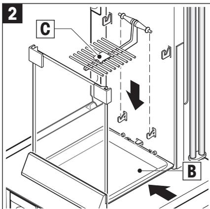
Setzen Sie die Auffangschale (B) ein. Schieben Sie diese von der Seite unter den oberen 2 Bolzen ein. Die Kerben müssen bei den Federn positioniert sein.
