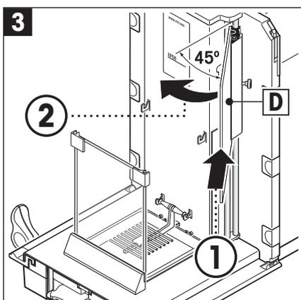
Setzen Sie das seitliche Innenwindschutz-Fenster (D) ein.
