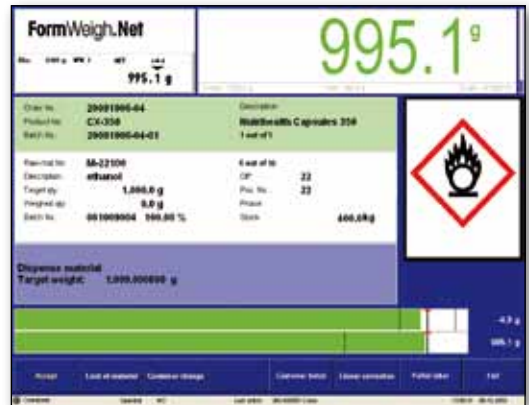
La barre de progression en temps réel est clairement visible pour l'opérateur et change de couleur en fonction du déroulement du pesage.
