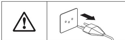
拔去仪器电源插头，等10分钟使发热元件冷却后才能开始工作！
