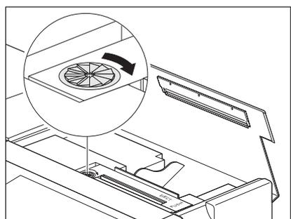
在色带盒左边按箭头所指方向转动小轮拉紧色带，色带拉紧后，关闭打印机盖。
