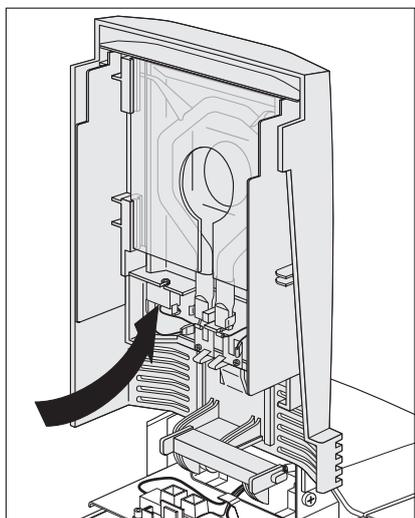
按压白色温度开关后部使热过载保护装置复位。
