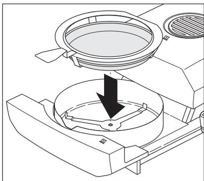
将空样品盘置于样品盘支架内(如果从侧面圆形凸缘下连接,将样品盘插入样品支架中可使样品盘保持水平)。将样品盘支架置于自动加样室中。确保支架上舌状片正确地放入有缺口的槽处。样品盘在样品盘支架内必须放置平整。
