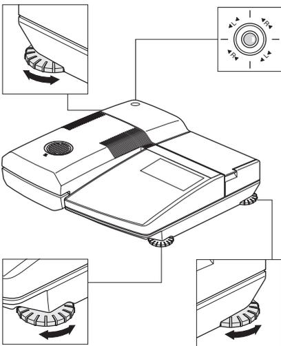
完全水平和安装稳定是获得可重复结果的前提.为补偿放置位置的不规则和倾斜( $\pm 2\%$ )，可调节仪器水平。
