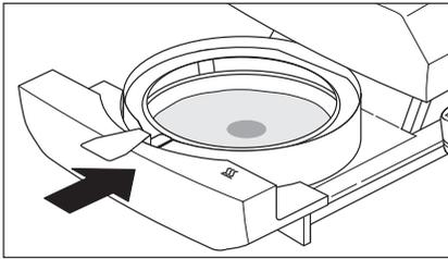
…电动自动加样室关闭。仪器开始使样品干燥和测量。
