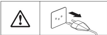
拔去仪器电源。等10分钟使发热元件冷却后才能开始工作！
