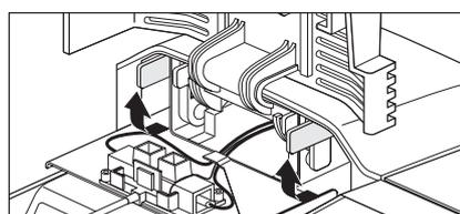
将两根黄色杆向前转90°，加热单元铰链不分开。
