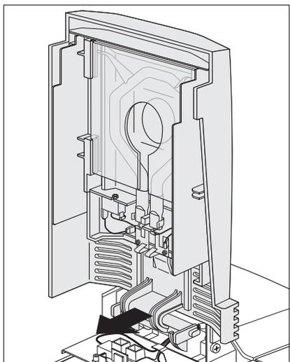
将自动样品室拉出2~3cm，使加热单元脱出。
