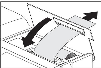
沿内置打印机封盖上的小槽拉出打印机，然后关上封盖。
