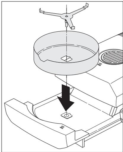
安装风挡(只有一个安装位置)和样品支架。旋转样品盘直至定位。当处于锁定位置时，样品盘支架的后柄正好指向自动加样室运动的方向。
