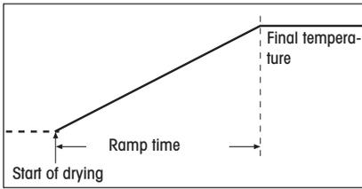
首先确定缓升时间，即干燥过程开始和达到最终温度所需时间，然后再选择干燥温度(最终温度)。一旦温度达到50°C，即开始缓升干燥。
