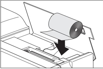
把打印纸卷入纸盒内并从打印机单元后部的小槽内水平送纸。
