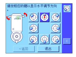
密切观察天平上的水平指示器,并按下与水平指示器中的当前气泡位置一致的 按钮。
