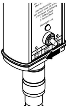
Drücken Sie den Schalter **nach links** auf die Position "**1 – Battery check**". Der O<sub>2</sub> Sensor-Master prüft die Polarisationsspannung. Leuchtet die grüne LED ist die Batterie ok und das Gerät liefert die korrekte Polarisationsspannung. Leuchtet die LED nicht, muss die Batterie ersetzt werden (siehe Kapitel 2.3). Falls die LED auch nach einem Batteriewechsel nicht leuchtet, senden Sie den O<sub>2</sub> Sensor-Master bitte an Ihren METTLER TOLEDO Vertreter.
