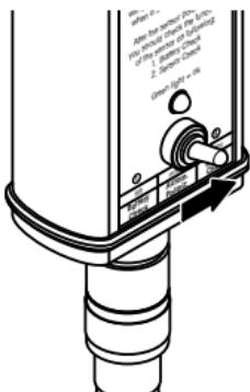
Halten Sie den am O<sub>2</sub> Sensor-Master angegeschlossenen Sensor in die Luft. Drücken Sie anschliessend den Schalter **nach rechts** auf die Position **“2 – Sensor check”**. Der O<sub>2</sub> Sensor-Master prüft, ob der Elektrodenstrom für Luft, den der Sensor liefert, im zulässigen Bereich liegt (40 bis 100 nA für den InPro 6800; 250 bis 500 nA für den InPro 6900; 2500 bis 6000 nA für den InPro 6950).
