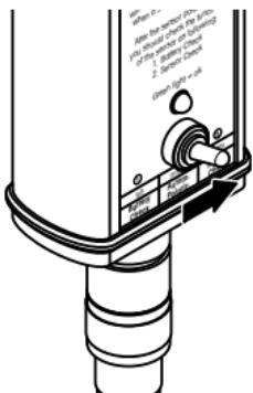
Tenir la sonde connectée au O<sub>2</sub> Sensor-Master dans l'air et pousser l'interrupteur **vers la droite** en position "**2-Sensor check**". Le O<sub>2</sub> Sensor-Master contrôle alors le courant de la sonde dans l'air ambiant. Ce dernier doit se trouver dans un domaine de valeurs prédéterminé (40 à 100 nA pour l'InPro 6800, 250 à 500 nA pour l'InPro 6900 et 2500 à 6000 nA pour l'InPro6950).
