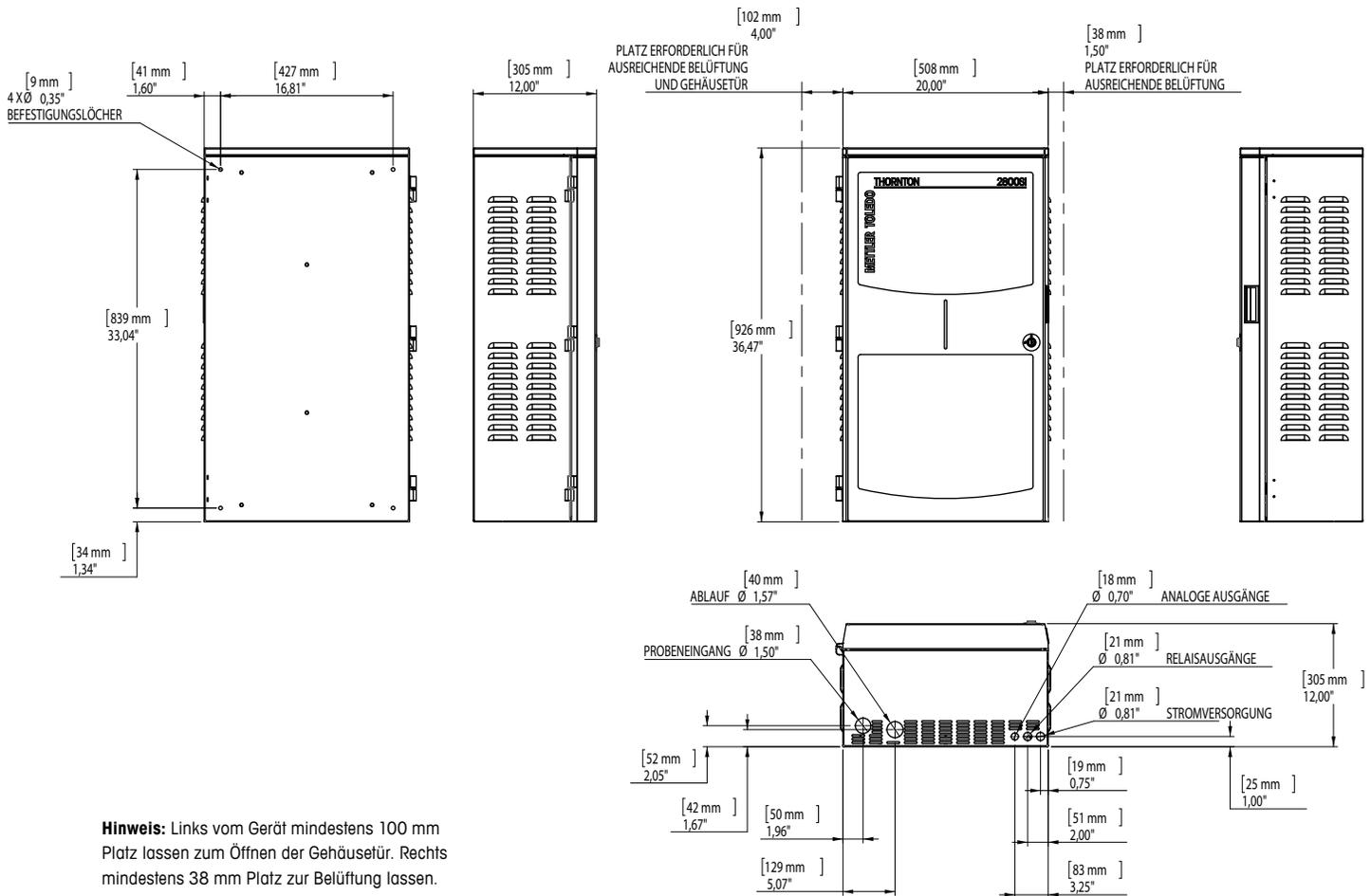
**Hinweis:** Links vom Gerät mindestens 100 mm Platz lassen zum Öffnen der Gehäusetür. Rechts mindestens 38 mm Platz zur Belüftung lassen.
