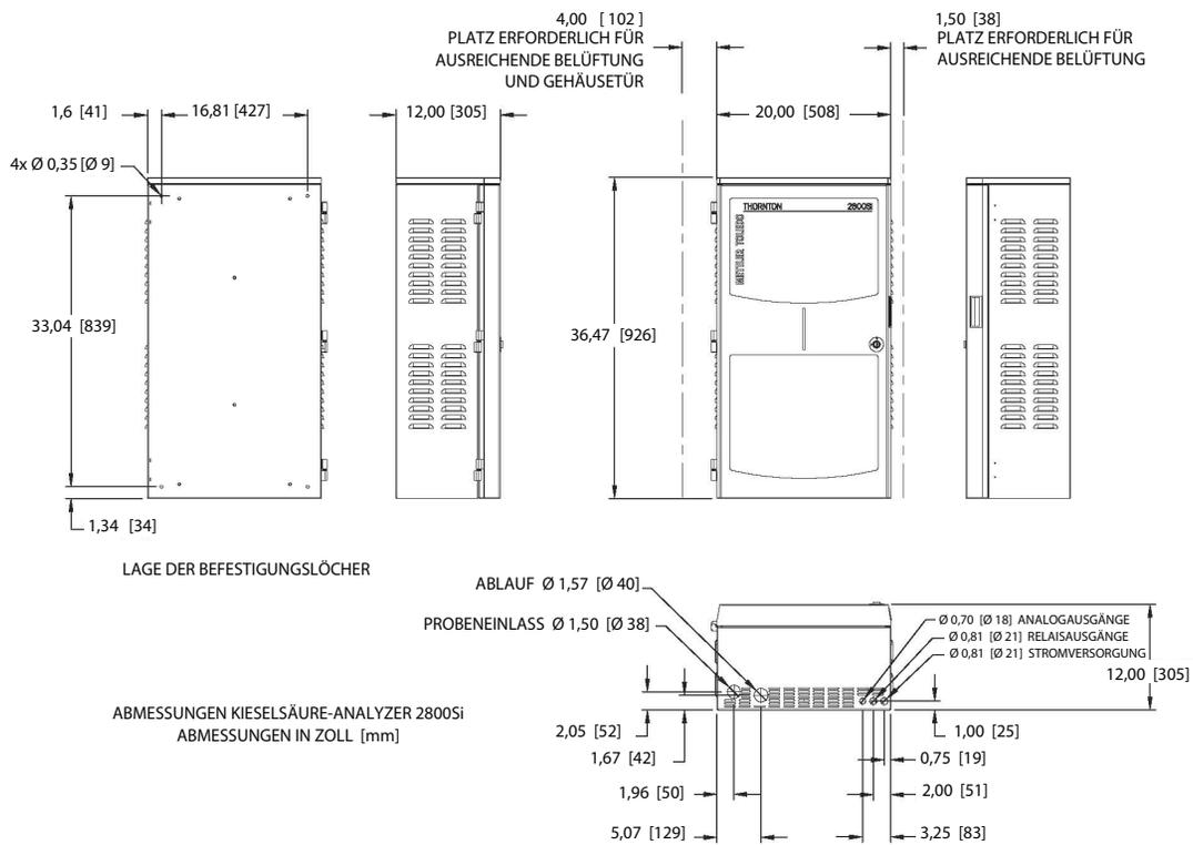
**Hinweis:** Links vom Gerät mindestens 100 mm Platz lassen zum Öffnen der Gehäusetür. Rechts mindestens 38 mm Platz zur Belüftung lassen.
