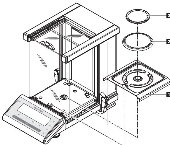
将两侧的玻璃门尽量往后推，然后按下面的指定顺序
