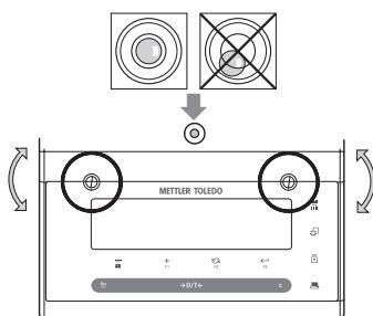
所有型号的天平均有一个水平指示器和两个水平调节脚，以弥补称量操作台面上的细微不平整对称量结果的影响。将气泡调至中央时，天平就处于完全水平状况。
