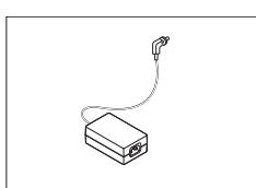
交流/直流适配器（无电源线）100–240 VAC, 0.8 A,
