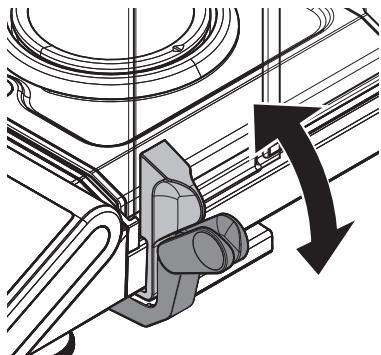
天平的玻璃防风罩可进行相应调整，以适应环境条件、称量习惯、称量类型及负载类型。
