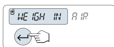
天平提示您在空气中测量液体密度测量块“WEIGH IN AIR”。
