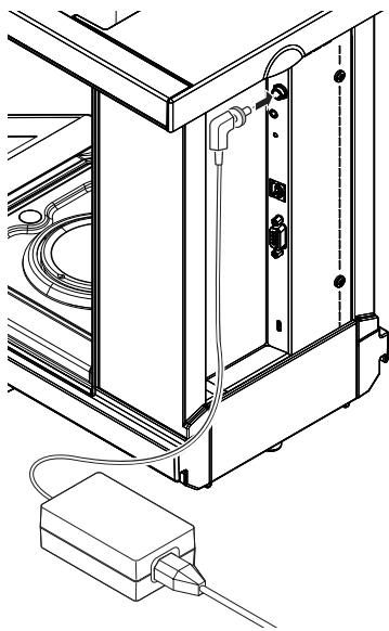
将 AC 电源适配器与天平后端的接口相连（请参照数据），并接上电源。拧紧插头，确保天平电源线连接牢固。
