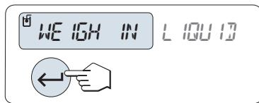
天平提示您在辅助液体中称量固体“WEIGH IN LIQUID”。
