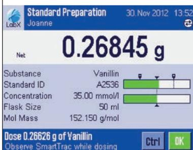
LabX fornisce all'utente una guida dettagliata sullo schermo touchscreen della bilancia, per garantire all'operatore la corretta applicazione delle SOP. Tramite la gestione centralizzata degli strumenti, su tutte le bilance vengono visualizzate automaticamente le stesse istruzioni relative alle SOP, al fine di assicurare coerenza nel laboratorio.
