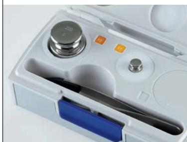
CarePacs® include tutto ciò di cui avete bisogno per verificare le vostre bilance in base alla normativa USP 41: due pesi di prova corrispondenti al 5% e al 100% della portata della bilancia. Sono inoltre inclusi pinzette, guanti e altri accessori per operazioni di pesata professionali.
