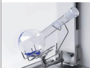
Il dosaggio diretto nel contenitore di tara evita errori di trasferimento e consente di risparmiare denaro, riducendo al minimo la perdita di campione. Persino contenitori di forma insolita possono essere tenuti correttamente in posizione. In combinazione con MinWeigh Door™, ErgoClips consente di raggiungere la pesata minima più bassa possibile.
