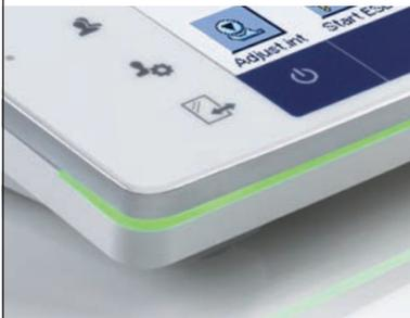
La funzione StatusLight, integrata nel terminale, usa il colore per indicare lo stato della bilancia in modo intuitivo: verde significa "bilancia pronta", giallo indica un avviso e rosso eventuali errori. StatusLight indica se la bilancia è pronta per iniziare l'attività di pesata.
