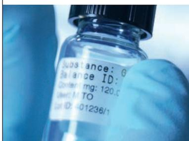
Evitate errori di trascrizione con stampe conformi a tutti gli standard di qualità GxP, che consentono tracciabilità completa. Le etichette dei campioni dotate di codici a barre possono inoltre essere stampate direttamente dalla bilancia. Una stampante Bluetooth® posizionata al di fuori delle aree sensibili consente di evitare la contaminazione della stampante e delle stampe.
