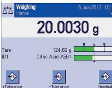
La funzione SmartTrac™ con guida a colori semplifica il dosaggio secondo il peso target e aiuta a rimanere entro le tolleranze. Utilizzando i supporti ErgoClip appropriati, è possibile dosare direttamente nel contenitore, con un unico semplice passaggio.
