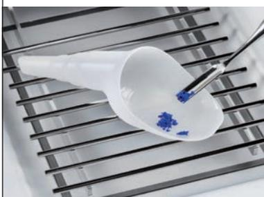
L'imbuto di pesata monouso SmartPrep™ è realizzato in materiale antistatico e destinato a pesate semplici e sicure delle polveri. Il design esclusivo consente di dosare facilmente e di versare efficacemente le polveri nei matracci, riducendo al minimo la perdita di campioni.
