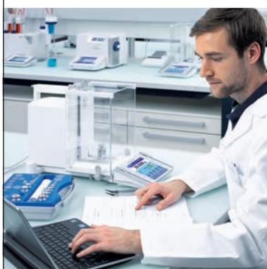
La taratura della bilancia è fondamentale per risultati di pesata accurati. Ogni certificato di taratura dichiara la pesata minima e l'incertezza di misura della bilancia, informazioni essenziali per processi di pesata affidabili.
