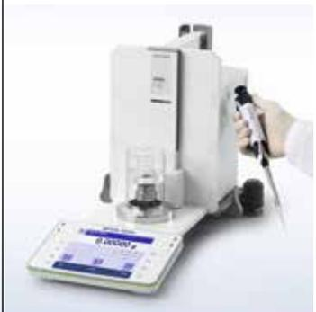
Bei einer Pipette mit RFID-Etikett wird die Prüfung automatisch eingeleitet. Das Etikett enthält die Pipettendaten, das Prüfintervall und die Methode. Wenn eine Prüfung bestanden wurde, wird das nächste Prüfdatum auf der Pipette gespeichert.
