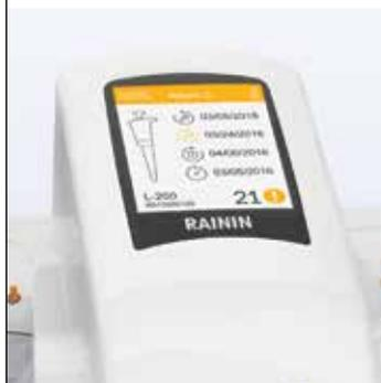
SmartStand zeigt die Prüf-, Kalibrier- und Wartungsdaten an, die auf jeder Rainin XLS-Pipette gespeichert werden können.
