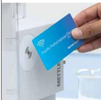
EasyDirect kann RFID-MethodCards erstellen, mit denen Sie in kurzer Zeit gesteuerte Prüfungen für jede Pipette ohne RFID-Etikett durchführen können.
