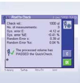
Die XPE-Waage ist standardmässig mit einer intuitiven Schritt-für-Schritt-Benutzerführung ausgestattet. Auf Grundlage der ISO 8655 berechnet sie alle Ergebnisse automatisch und zeigt Pass/Fail-Entscheidungen an.
