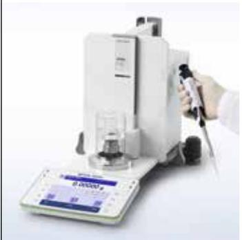
En el caso de las pipetas con chip RFID, la comprobación se inicia de forma automática. El chip contiene los datos de la pipeta, el intervalo de comprobación y el método. Cuando la comprobación se realiza correctamente, la siguiente fecha se almacena en la pipeta.
