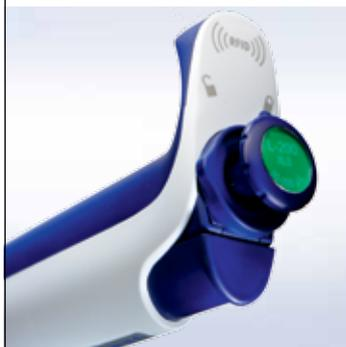
Les pipettes avec étiquette RFID sont automatiquement mises à jour par la balance XPE avec un outil de lecture/écriture RFID EasyScan.
