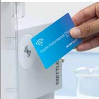
EasyDirect peut créer des MethodCards RFID qui vous permettent de réaliser rapidement des contrôles guidés pour toutes les pipettes ne disposant pas d'une étiquette RFID.
