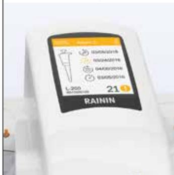
SmartStand affiche les dates de contrôle, d'étalonnage et d'entretien stockées sur chaque pipette Rainin XLS.
