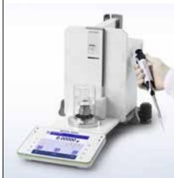
Le contrôle est lancé automatiquement sur les pipettes avec étiquette RFID. L'étiquette contient les données de la pipette, l'intervalle et la méthode de contrôle. Lorsque le contrôle est effectué, la date suivante est enregistrée sur la pipette.
