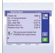
La bilancia XPE viene fornita di serie con una guida step-bystep facile da utilizzare. Basata sulla norma ISO 8655, calcola tutti i risultati automaticamente e stabilisce se il test è stato superato o meno.
