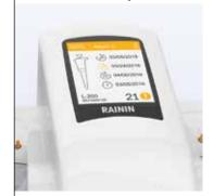
SmartStand visualizza le date delle operazioni di controllo, taratura e manutenzione che è possibile memorizzare su ogni pipetta Rainin XLS.
