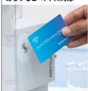
EasyDirectでは、RFIDタグのないあらゆるピペットでもガイドに従ってすばやくチェックを実施できるRFID MethodCardを作成できます。
