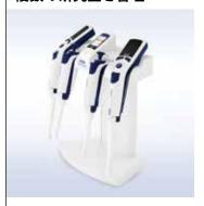
EasyDirectはサーバーとして設定すれば、さまざまな研究室のSmartStandにリンクし、ピペットの使用状況と場所を遠隔監視することができます。ピペットがサービスから戻ると、SmartStandはEasyDirectデータベースに新しいサービス日を自動更新します。
