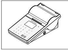
Impresora térmica P-58RUE con conexiones RS232C, USB y Ethernet, tickets impresos sencillos, fecha y hora, impresión de etiquetas, aplicaciones de balanza: estadísticas, formulación, totalización,
