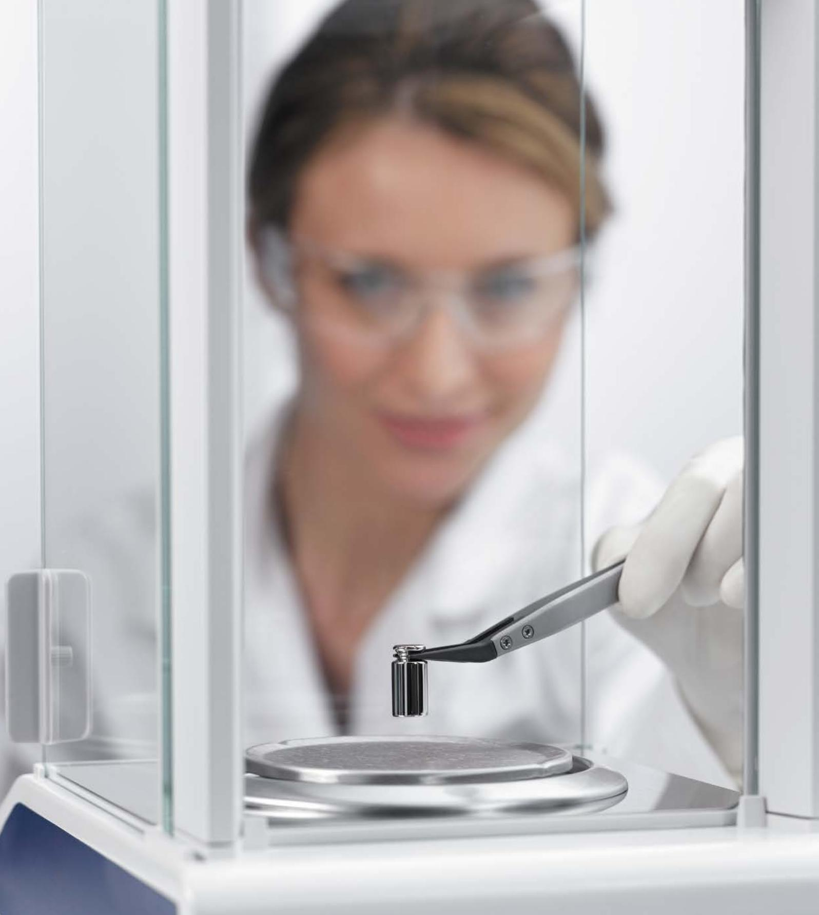
Die eingebaute ISO-Log-Funktion sorgt für eine vollständige Rückführbarkeit aller wägerelevanten Einstellungen Ihrer Waage. Alle Änderungen, die bei Routineprüfungen oder über FACT vorgenommen wurden, werden automatisch protokolliert.
