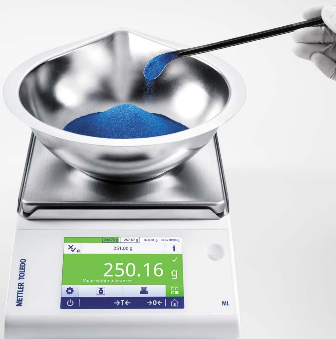
La guida alla pesata sul display assicura un dosaggio accurato. Lo schermo verde indica chiaramente che il risultato della pesata rientra nelle tolleranze di processo.
