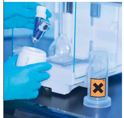
Il dosaggio diretto nel contenitore target evita le fuoriuscite durante le operazioni di pesata manuali e il trasferimento di polveri. La pulizia semplice e rapida minimizza l'esposizione dell'operatore a materiali tossici.
