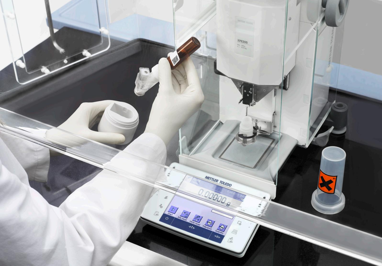
Il sistema di dosaggio delle polveri automatico Quantos protegge gli utenti dall'esposizione a sostanze potenti.
