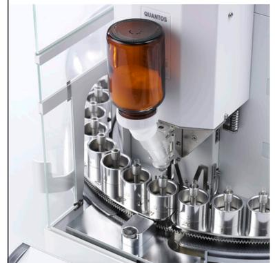
Aumentate la produttività utilizzando uno scambiatore di campioni per riempire fino a 30 contenitori alla volta. Questo processo completamente automatico richiede un intervento minimo da parte dell'utente e consente di risparmiare tempo.
