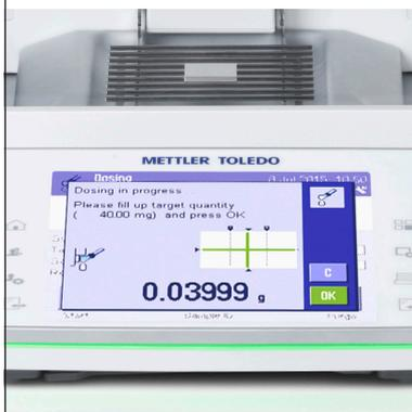
Quantos può dosare da 1 milligrammo a 5 grammi di polvere non agglomerante direttamente nel contenitore target. Il processo di dosaggio altamente accurato elimina la variabilità e i risultati fuori specifica.
