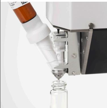
Non è più necessario che gli operatori pesino composti potenti o tossici utilizzando una spatola e un imbuto di pesata: grazie al processo di dosaggio automatico, possono lavorare in modo sicuro senza esporsi alle sostanze durante la pesata.
