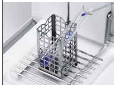
Der ErgoClip-Korb erfüllt die Funktion eines Faradayschen Käfigs und schützt die Waage vor elektrostatisch aufgeladenen Proben und Gefäßen. Er gehört zur Standardausstattung sämtlicher Analysenwaagen.
