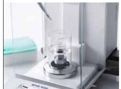
Für Routinetests von Pipetten kann in Sekundenschnelle eine Verdunstungsfalle an der Waage montiert werden, die den Feuchteverlust der Testflüssigkeit deutlich reduziert.
