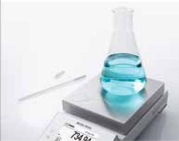
Die MPS-Waagschale (Magnetic Protection Shield) schützt vor den Einflüssen magnetischer Proben und Rührstäbe, um genaue Resultate zu gewährleisten.
