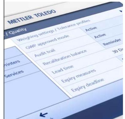
Durch den Einsatz von Toleranzprofilen können Sie gewährleisten, dass Ihre Wägearbeiten den definierten Qualitätsanforderungen und -bestimmungen entsprechen. Da zudem jedes Mal, wenn Sie eine bestimmte Arbeit durchführen, dasselbe Profil verwendet wird, können Sie von konstanten Einstellungen ausgehen, um rückverfolgbare Resultate zu erzielen.
