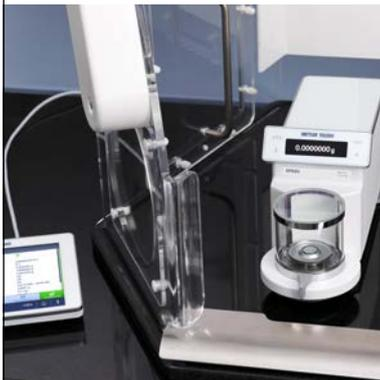
Die XPR-Waage benötigt die geringste Stellfläche aller Mikrowaagen auf dem Markt. Zusätzlicher Vorteil ist die Möglichkeit das Hauptterminal dort zu plazieren, wo es am besten erreichbar ist – selbst ausserhalb Ihrer Wägekabine.
