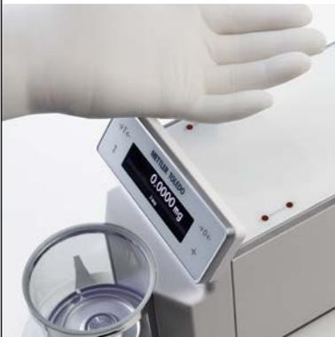
Mit den SmartSens-Infrarotsensoren können Sie die Windschutztüren mit einer einfachen Handbewegung bedienen. Durch diese berührungslose Waagenbedienung wird das Risiko von Kreuzkontamination verringert.
