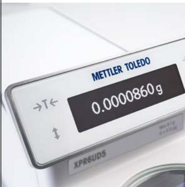
Selbst unter anspruchsvollen Wägebbedingungen bieten XPR-Mikrowaagen eine einzigartige Präzision bei extrem niedrigen Mindesteinwaagen. Die XPR6UD5-Waage bietet eine Ablesbarkeit von 0,5 µg mit einer um 25 % verbesserten Wiederholbarkeit.
