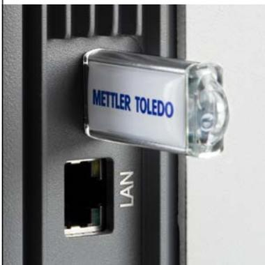
Es sind keine handschriftlichen Aufzeichnungen oder unnötige Zeit für Dateneingabe mehr nötig. Übertragen Sie Aufgabenparameter und Resultate einfach über USB auf einen PC oder eine Softwareanwendung. Übertragungsfehler werden somit verhindert und die Integrität Ihrer Daten wird geschützt.
