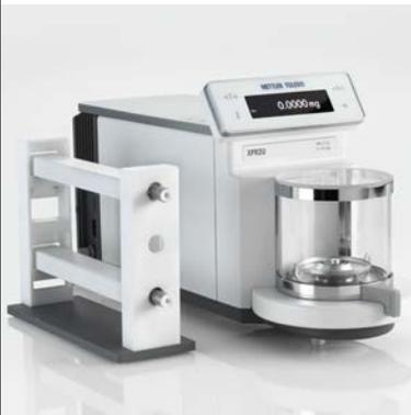
Zur Bewältigung einer der wichtigsten Herausforderungen beim Mikrowägen entfernt der freistehende Ionisator elektrostatische Aufladungen von Proben und Gefässen.
