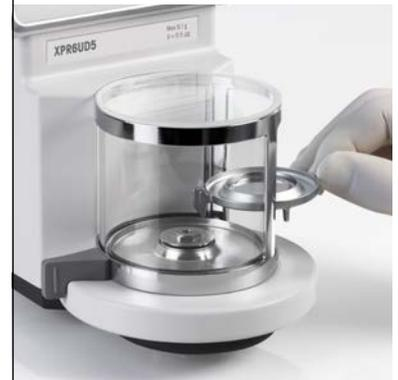
Der neu entwickelte Windschutz bietet einfachen Zugriff auf die Waagschale. Es gibt keine Ecken und Kanten, an denen sich Probenmaterial ansammeln könnte. Alle Teile lassen sich in wenigen einfachen Schritten ausbauen, reinigen und wieder einbauen.
