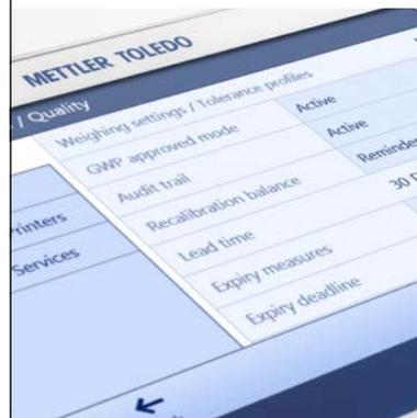
Impostando i Profili di tolleranza, è possibile garantire che le operazioni di pesata soddisfino i requisiti di qualità e le normative in vigore. Inoltre, poiché si utilizza lo stesso profilo ogni volta che si esegue un'attività specifica, potete garantire risultati sempre tracciabili.
