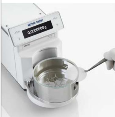
Installate in pochi secondi il kit per filtri sulla vostra microbilancia per una determinazione pratica e accurata delle polveri sottili depositate sui filtri.
