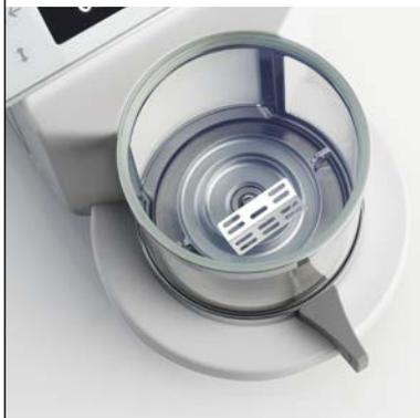
Questo supporto flessibile è ideale per garantire il posizionamento sicuro dei campioni di forma tubolare (ad esempio gli stent).
