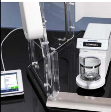
La XPR è caratterizzata dall'ingombro più ridotto di qualsiasi altra microbilancia disponibile sul mercato, con in più la praticità di poter collocare il terminale principale dove è più facilmente accessibile, anche all'esterno dell'armadio di sicurezza.
