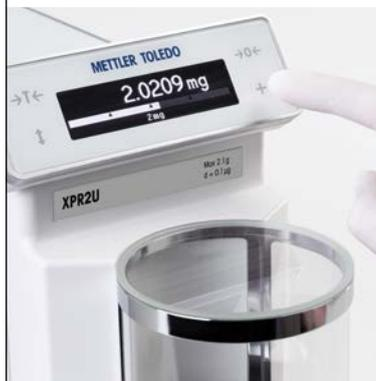
Il terminale SmartView è esattamente dove vi serve quando eseguite le operazioni di pesata. Grazie alla guida per l'utente su schermo, avete a portata di mano tutte le funzioni di base, tra cui: tara, zero, paravento aperto e accettazione del risultato di pesata.
