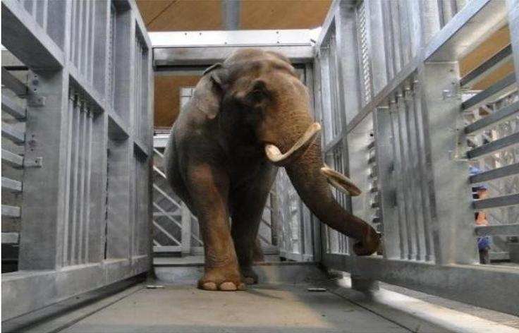
**Der Zoo Zürich setzt bei der Gewichtskontrolle seiner Elefanten auf eine kundenspezifische Wägeplattform von METTLER TOLEDO. Die Feuerprobe hat die Waage bestanden, alle Tiere wurden bereits gewogen. Dass sich die Platte über den Wägezellen um ein paar Millimeter bewegt, ist den Tieren noch etwas suspekt.**
