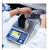
Durante l'uso di sistemi di pesatura per il conteggio pezzi o per le verifiche di completezza, gli operatori in genere devono concentrarsi sul display per verificare i risultati e questo rallenta il processo. La funzionalità ColorWeight® indica chiaramente, mediante l'uso di colori diversi, quando l'obiettivo viene raggiunto: non richiede alcuno sforzo da parte dell'operatore e consente di risparmiare tempo e denaro.
