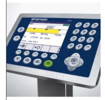
Gli strumenti impiegati nelle aree soggette a standard igienici elevati come gli ambienti produttivi alimentari devono essere progettati e installati secondo appropriati standard sanitari. La linea di prodotti ICS689 è stata progettata secondo le ultime linee guida in materia di design igienico, tra cui EHEDG o NSF. Include un indicatore a doppia tenuta, con grado di protezione IP69K.
