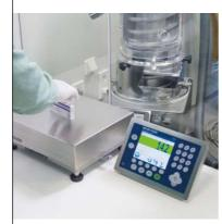
Il controllo peso è un metodo facile e conveniente per garantire la qualità dei prodotti, soprattutto quando l'integrità di quest'ultimi è fondamentale. Che dobbiate rilevare dei componenti mancati all'interno di gruppi o di intere spedizioni, verificare la completezza delle fusioni o la quantità di lubrificanti applicata, le bilance ICS forniscono informazioni chiare riguardo al rispetto delle specifiche di qualità e lo stato della spedizione.
