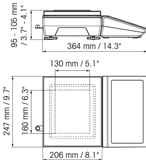
**Balanza compacta ICS4\_5 con plataforma de pesada XS y antiviento**
