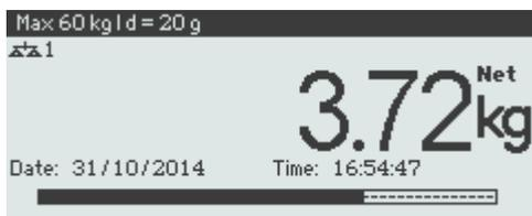
Le diagramme à barres indique grossièrement dans quelle mesure la capacité de la balance est déjà occupée et quelle est la capacité encore disponible.
