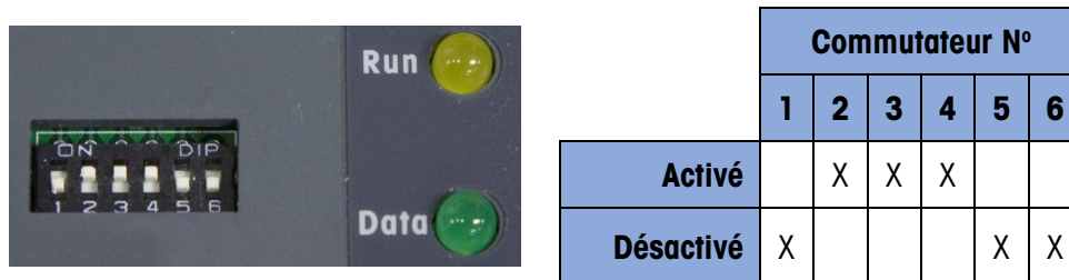
Figure 2-10: Réglages des commutateurs DiP de l'ARM100
