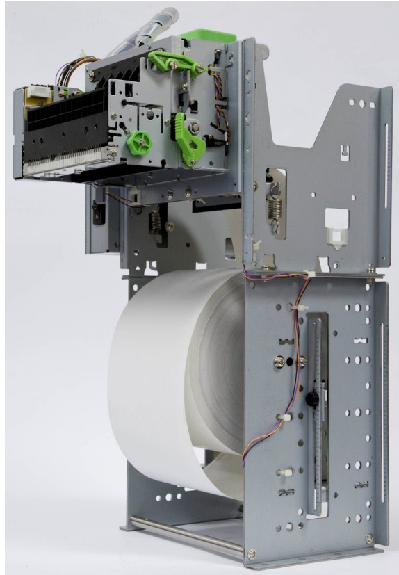
Figura 2-17: Rollo de papel cargado correctamente
