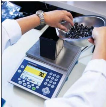
Beim Zählen von Teilen mit einem Wägesystem muss sich der Bediener normalerweise auf das Anzeigedisplay konzentrieren, wodurch der Prozess verlangsamt wird. Die colorWeight® Funktion zeigt das Erreichen der Sollstückzahl anhand unterschiedlicher Farben an. Auf diese Weise wird der Bediener entlastet und der Prozess beschleunigt, sodass Sie Zeit und Geld sparen.
