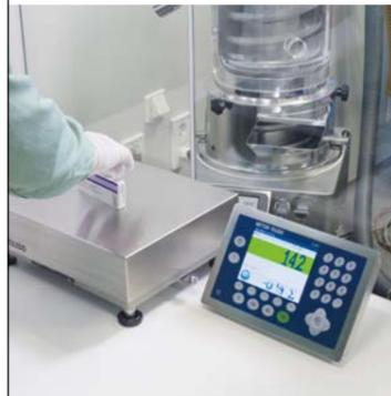
Wenn es um Produktintegrität geht, ist das Kontrollwägen eine schnelle und kosteneffektive Methode zur Qualitätssicherung. Ob es darum geht, fehlende Teile von Baugruppen oder ganzen Sendungen zu ermitteln, die Gussteile auf Vollständigkeit zu überprüfen oder um die verwendete Schmiermittelmenge zu kontrollieren: Die ICS-Waagen informieren deutlich darüber, ob die Qualitätsvorgaben erfüllt wurden und ob die Sendung vollständig ist.
