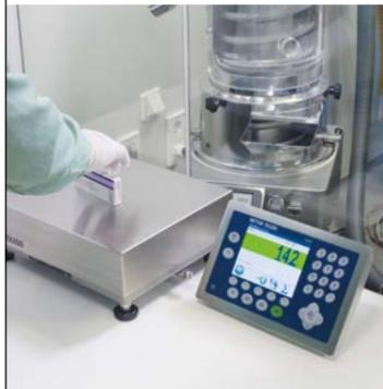
Cuando la integridad del producto es importante, el control de peso es un método de control de calidad rápido y rentable. Si tiene que detectar componentes perdidos de conjuntos o envíos completos, controlar la integridad de las fundiciones o verificar la cantidad de lubricantes aplicados, las básculas ICS ofrecen información clara acerca de si las especificaciones de calidad se cumplen y la expedición está completa.
