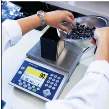
Mientras los operarios cuentan piezas o comprueban la integridad con un sistema de pesaje, normalmente deben concentrarse mucho en la pantalla del indicador, lo que ralentiza el proceso. La función colorWeight® indica, mediante diferentes colores, cuándo se alcanza el objetivo. Esto favorece la concentración del operario, acelera la tarea y permite ahorrar tiempo y dinero.
