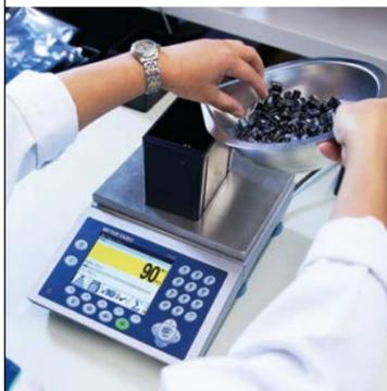
Lorsqu'ils comptent les pièces ou vérifient l'exhaustivité d'un colis à l'aide d'un système de pesage, les opérateurs doivent généralement se concentrer sur l'écran de l'indicateur, ce qui ralentit le processus. La fonction colorWeight® leur indique clairement lorsque le nombre cible est atteint à l'aide d'un code couleur. Ainsi, l'écran n'accapare pas l'attention de l'opérateur et ce dernier peut effectuer le comptage plus rapidement. Votre entreprise gagne ainsi du temps et de l'argent.
