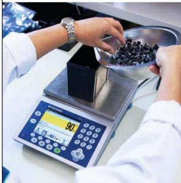
계량 시스템을 사용하여 단품을 세거나 완전성을 확인하는 경우 작업자는 보통 인디케이터 디스플레이에 매우 집중해야 하며 이는 공정 속도를 낮춥니다. colorWeight® 기능은 다양한 색상을 사용하여 목표에 도달한 경우 이를 명확하게 표시합니다. 이는 작업자의 집중에 대한 부담을 줄여 작업의 속도를 높이고 시간과 비용을 절감합니다.
