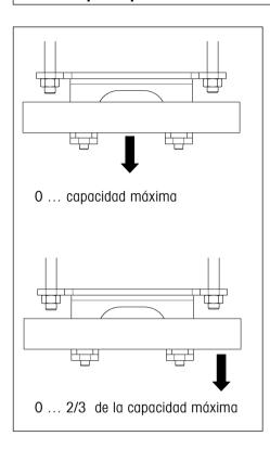
La capacidad máxima y, por tanto, el campo de pesada de su plataforma aérea depende de la configuración elegida (vea datos de configuración).
