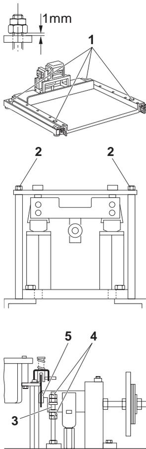
1. Die gelb lackierten Lastrahmensicherungsmuttern (1) an allen 4 Ecken lösen.
