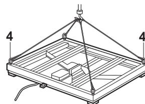
2. Wägebrücke von der Transportpalette abheben. Dazu die vier mitgelieferten Ringschrauben (4) an den Ecken in die Gewinde der Lastplattenbefestigung einschrauben und die Wägebrücke mit Kran, Flaschenzug oder dergleichen abheben und am Aufstellort absetzen.
