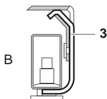
Die Abhebesicherungen sind einerseits Griffhilfe zum Abheben des Lastträgers (Pos. A), zum anderen Abhebe- und Kippsicherung (Pos. B) während des Wägebetriebs.
