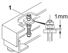
1. Die gelb lackierten Lastrahmensicherungsmuttern (1) an allen 4 Ecken lösen. Durch Hochdrehen und Kontern 1 mm Spiel einstellen.
