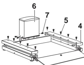
1. Ringschrauben abmontieren und die beiden Abdeckwinkel (4) mit den Schrauben (5) anschrauben.
