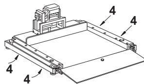
Die Wägebrücke KN1500 kann freistehend eingesetzt werden. Auf glatten Fußböden empfehlen wir jedoch eine Fußbodenbefestigung. Dazu sind im Grundwerksrahmen 4 Bohrungen (4) angebracht.
