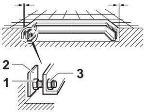
1. Lastplatte abnehmen und Anschlusskabel unter der Wägebrücke nach außen führen, siehe Abschnitt 1.2.2.
