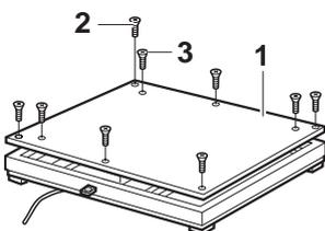
1. Soulever le plateau de charge (1) après avoir desserré les 6 ou 8 vis (2). Comme aide au soulèvement, on peut insérer dans les trous filetés les vis à anneau (3) fournies après avoir enlevé les vis aveugles. Selon le magasin d'expédition ou l'exécution commandée, le plateau de charge peut également être emballé séparément. Les vis de fixation ainsi que les vis aveugles sont alors fournies dans le sachet d'accessoires.
