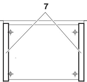
1. Placer le plan fourni dans la fosse comme gabarit de perçement. Centrer le gabarit dans tous les sens et le fixer avec une bande autocollante. Aux endroits marqués, effectuer les quatre percements et placer les chevilles.
