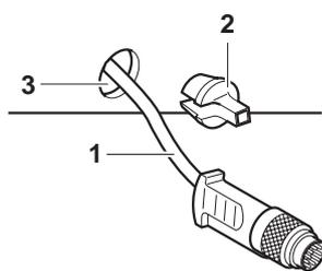
A titre de sécurité pendant le transport, le câble de raccordement (1) est rangé à l'intérieur de la plate-forme de pesage. Suivant les conditions régnant à l'emplacement d'installation, le câble de raccordement peut être guidé comme suit vers l'extérieur:
