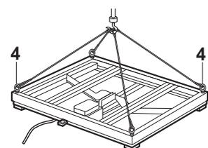
2. Soulever la plate-forme de pesage de la palette de transport. A cet effet, visser dans les coins les quatre vis à anneau (4) fournies dans les trous filetés de la fixation du plateau de charge et soulever la plate-forme de pesage à l'aide d'une grue, d'un palan ou engin similaire et la déposer à l'emplacement d'installation.
