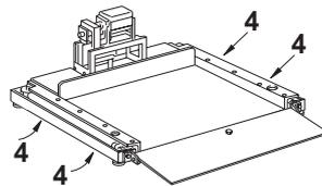
La plate-forme de pesage KN1500 peut être utilisée sans fixation au sol. Sur sols lisses, nous recommandons cependant une fixation au sol. A cet effet, le cadre de base comprend 4 perçages (4).
