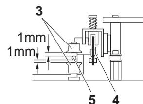
1. Desserrer les écrous peints en jaune de retenue du cadre de charge (1) dans les 4 coins. Régler un jeu de 1 mm par vissage et blocage avec un contre-écrou.
