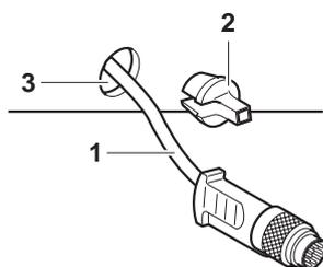
A titre de sécurité pendant le transport, le câble de raccordement (1) est rangé à l'intérieur de l'armoire. Suivant les conditions régnant à l'emplacement d'installation, le câble de raccordement peut être guidé comme suit vers l'extérieur:
