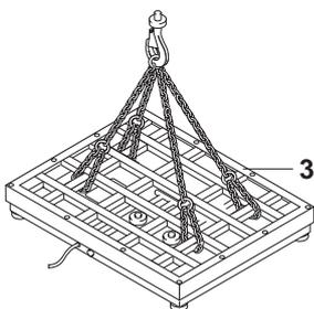
1. Soulever le plateau de charge (1) après avoir desserré les 12 vis (2). Selon le magasin d'expédition ou l'exécution commandée, le plateau de charge peut également être emballé séparément. Les vis de fixation ainsi que les vis aveugles sont alors fournies dans le sachet d'accessoires.
