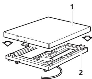
1. Guider le câble de raccordement vers l'extérieur en dessous du cadre de base.
