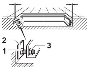
1. Enlever le plateau de charge et guider le câble de raccordement vers l'extérieur en dessous de la plate-forme de pesage, voir section 1.2.2.
