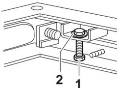
1. Desserrer les écrous (1) dans les quatre coins. Visser les vis de blocage (2) vers le haut et régler le jeu de manière régulière à env. 1 mm dans les quatre coins.
