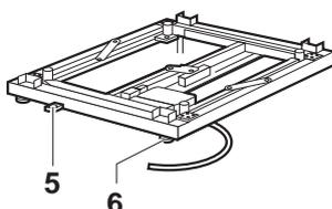
1. Aux quatre vis de pieds (6), niveler la plate-forme de pesage à l'aide du niveau à bulle d'air (5): la bulle du niveau doit venir au repos centrée dans la marque annulaire.
