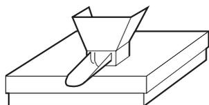
Le poids des pièces de construction qui sont montées rigidement sur la plate-forme de pesage est appelé "charge préalable". La charge préalable est compensée électriquement dans la plate-forme de pesage, afin de disposer de la plage complète de pesée.
