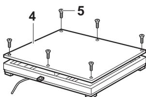
1. Placer le plateau de charge (4) (rabattu) et le fixer avec les vis (5) (fermetures rapides).
