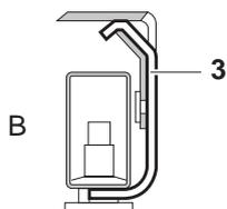
Les sécurités contre le soulèvement servent d'une part de poignées pour soulever le porte-charge (pos. A), d'autre part elles forment une sécurité contre le soulèvement et le basculement (pos. B) pendant le pesage.
