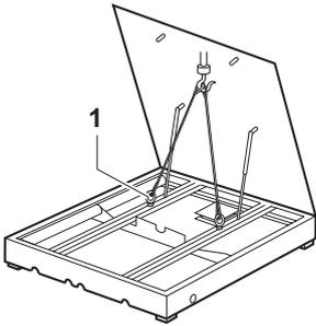
1. Avec la clé spéciale, ouvrir les deux fermetures rapides et déployer le plateau de charge (la clé spéciale sert d'aide au soulèvement).
