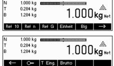
... lesen Sie anschließend das angezeigte Nettogewicht ab. Drücken Sie «—», um weitere Funktionstasten anzuzeigen.
