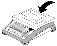
Bringen Sie den **leeren** Wägebehälter oder die Verpackung auf die Waage auf und drücken Sie anschließend kurz die «→T←»-Taste oder drücken Sie die Funktionstaste «T Eing.», wenn das Taragewicht bereits bekannt ist.
