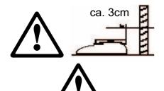
Ist das **Anschlusskabel** beschädigt, darf die Waage nicht mehr betrieben werden. Prüfen Sie deshalb das Kabel in regelmäßigen Abständen und vergewissern Sie sich, dass an der Waagenrückseite ein Abstand von ca. 3 cm eingehalten wird, damit das Kabel nicht zu sehr abgeknickt wird.
