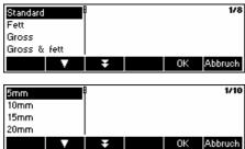
Wählen Sie "Zeichensatz", um das Layout des Ausdrucks zu verändern. (Dieser Menüpunkt ist beim Druckertyp "ASCII" und "Andere" nicht verfügbar)
