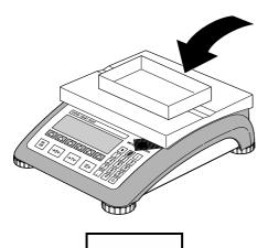
Bringen Sie den **leeren** Behälter auf die Waage auf und tarieren Sie mit der Taste  $\leftarrow T$
