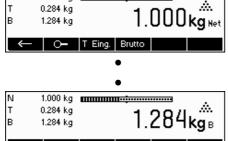
Drücken Sie die Taste **«Brutto»**. Mit dieser Funktion wird das Bruttogewicht angezeigt (das Symbol "B" erscheint und ersetzt das "Net"—Symbol). **Hinweis: «Brutto»** ist standardmäßig nicht definiert und muss separat im Vision Setup definiert werden. Zur Definition der Funktionstaste **«Brutto»** siehe
