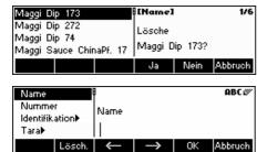
Drücken Sie «**Löschen**», um den aktuellen Artikel aus der Datenbank zu entfernen. Sie werden aufgefordert, das Löschen des Artikels zu bestätigen.
