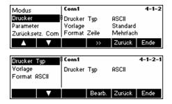
Die aktuellen Einstellungen des Druckers werden auf der rechten Bildschirmseite angezeigt. Drücken Sie die Taste « », um in das Menü der Druckereinstellungen zu gelangen.
