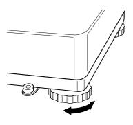
Drehen Sie die Stellfüße, damit die Waage horizontal steht. Ist eine Libelle vorhanden, muss sich deren Luftblase im Zentrum befinden.
