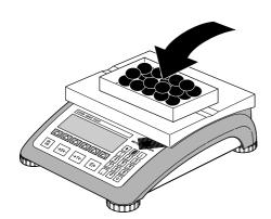
Wurde eine **abweichende Anzahl an Teilen** auf die Waage aufgebracht, drücken Sie die Taste «**Ref n**» und wählen Sie **5, 20, 30, 40 oder 50 Teile** aus. Ist die Stückzahl eine andere, drücken Sie die Taste «**Var**» und geben Sie die gewünschte Stückzahl ein.
