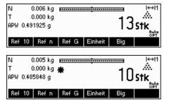
Smart Count ist nun zur Stückzählung bereit, unter Einbeziehung des optimierten (mittleren) Stückgewichts.
