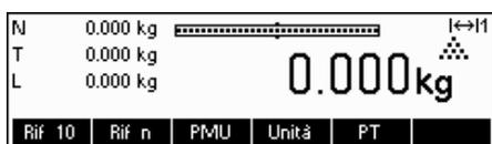
Viene attivato un test del display (Capitolo 1.4). Quando compare la schermata di peso, la bilancia è pronta per essere utilizzata e si azzerata automaticamente.
