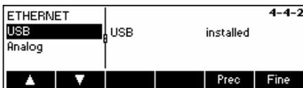
Viene visualizzato lo stato attuale dell'opzione USB. Non è disponibile un'ulteriore configurazione dell'interfaccia USB all'interno del Setup Visione.
