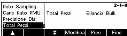
Se si seleziona 'Bilancia bulk' (default), solo i pezzi posti sulla bilancia bulk verranno visualizzati.
