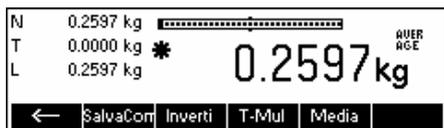
Dopo 10 secondi, Smart Count visualizzerà il peso medio del carico. Si noti che l'indicatore 'MEDIA' nell'angolo superiore destro del display è visibile in modalità Pesata media.
