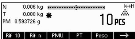
Quando sopraggiunge la richiesta di aggiungere pezzi sulla bilancia, si può evitare di effettuare il controllo del peso minimo del campione premendo il tasto «C». Questo consentirà di utilizzare il peso calcolato, ma si noti che sul display compare un "\*" a indicare che il peso del campione è inferiore alla percentuale di precisione desiderata.
