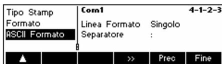
**Linea Formato: Singolo** I dati sono trasmessi senza cambio linea. Verrà inserito un separatore tra un carattere e un valore, come definito nel menu "Separatore".
