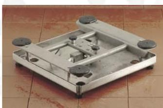
La base WH incorpora una celda de carga herméticamente sellada para una eficiencia y protección máxima en estos ambientes dañinos. La construcción de la celda de carga, en acero inoxidable, también ofrece protección contra los agentes de limpieza y los agentes corrosivos que con frecuencia se encuentran en sitios industriales y de preparación de alimentos.
