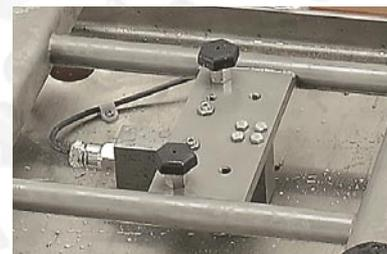
La resistente base para báscula WH suministra una alta eficiencia para pesar en los ambientes más difíciles de lavado. Está diseñada específicamente para ser utilizada en las industrias alimenticia y química - y en cualquier otra industria en la que sea esencial la resistencia a una humedad alta, al lavado de alta presión, y a los agentes corrosivos.
