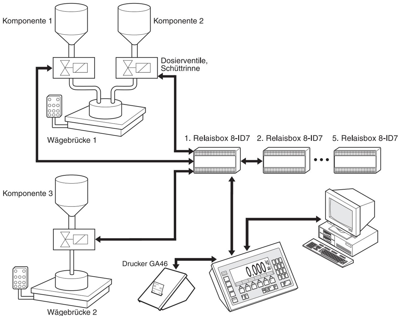
Die Steuersignale für die Dosierventile der einzelnen Komponenten werden über die Schnittstelle RS485-ID7 an bis zu fünf Relaisboxen 8-ID7 übertragen. Die Relaisboxen 8-ID7 steuern die Dosieranlage entweder direkt oder über eine zusätzliche externe Steuereinheit (SPS). Die Komponenten können direkt oder binär codiert abgegriffen werden (siehe Abschnitt 7.1).
