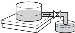
Beim Herausdosieren stellen Sie einen gefüllten Vorratsbehälter auf die Wägebrücke und dosieren in den Abfüllbehälter.
