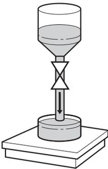
Beim Eindosieren stellen Sie einen leeren Abfüllbehälter auf die Wägebrücke und dosieren von einem Vorratsbehälter in den Abfüllbehälter.
