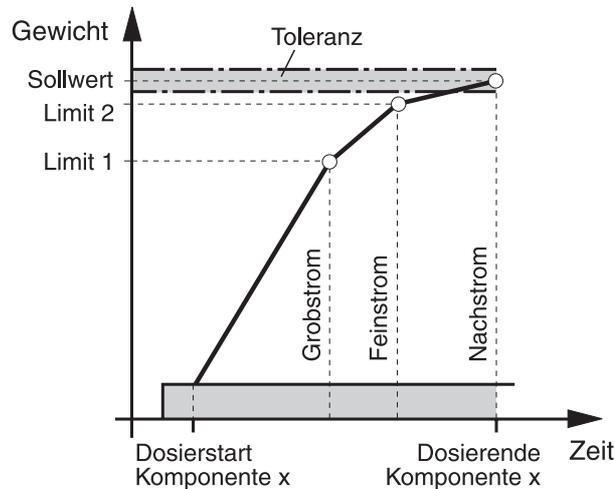
Wenn keine Limits für eine Einzelkomponente eingegeben werden, ermittelt das ID7-Dos-R automatisch Limit 1 und Limit 2 im LERNMODE, siehe Abschnitt 3.1.2. Das Sollgewicht der Komponente wird dann exakt erreicht.
