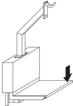
Der Wägebereich umfasst bei **zentrisch** aufgebrachtener Last den ganzen Bereich, vom Nullpunkt bis zur Höchstlast auf dem Klapptisch.
