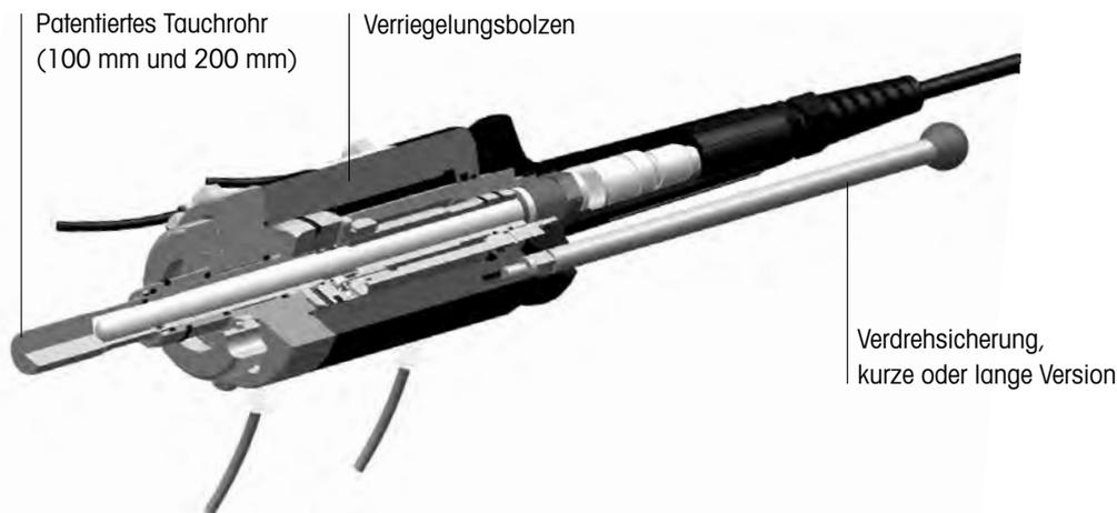
Die Verdrehsicherung verhindert einerseits, dass sich das Tauchrohr mit dem Sensor aus der vorgesehenen Lage drehen kann und damit die Öffnungen für die Spülleitungen nicht mehr optimal positioniert sind, andererseits erschwert es den Ausbau des Sensors im eingefahrenen Zustand und vermindert somit das Risiko einer Fehlmanipulation. Die Verdrehsicherung wird optional mit den Armaturen des Typs InTrac777 e/779e sowie 779e/799e geliefert.
