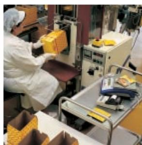
La Viper MonoBloc convient pour le contrôle par échantillonnage des préemballés. Mobilité assurée par AccuPac et possibilité de raccordement d'imprimantes (Sprinter ou SQC14 pour les statistiques). Le clavier à membrane protège la partie frontale de l'eau et de la poussière. Une housse en option assure une protection supplémentaire.
