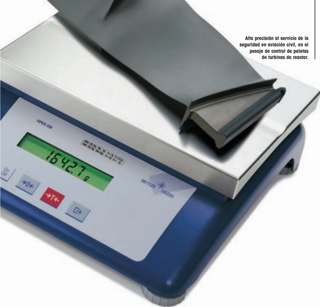
Alta precisión al servicio de la seguridad en aviación civil, en el pesaje de control de paletas de turbinas de reactor.
