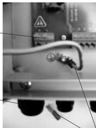
Für Schutzleiteranschluss muss beigelegte Flachsteckhülse mit Doppelpressstelle verwendet werden.
