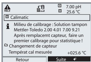
Lors de l'enregistrement automatique de la température de calibrage, le M700 mesure la température de la solution tampon à l'aide d'une sonde de température
